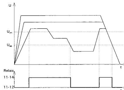
Das Meßprinzip bedingt, daß die Ansprechzeit und die Rückfallzeit von der Größe des Verhältnisses zwischen Meßspannung  $U_m$  und Einstellwert  $U_{set}$  abhängig sind.
